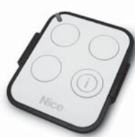
ON3EBD 3 kanálová obousměrná vysílačka 433,92 MHz
