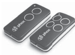
FOX 2; 4-tlačítkový dálkový rádiový ovladač, 433,92 MHz
